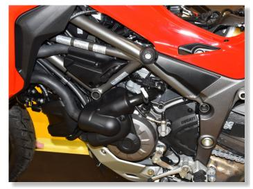
PLUG GIPRO CONNECTORS IN-LINE WITH THE GEAR POSITION SENSOR CONNECTORS.
