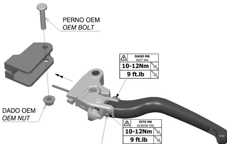
**⚠ ATTENZIONE:** PRIMA DI METTERSI ALLA GUIDA DEL MOTOCICLO CONTROLLARE IL CORRETTO SERRAGGIO DELLA VITE E DEL DADO.
